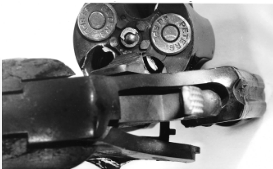
Revolver med ammunition som har exploderat av hettan i branden
